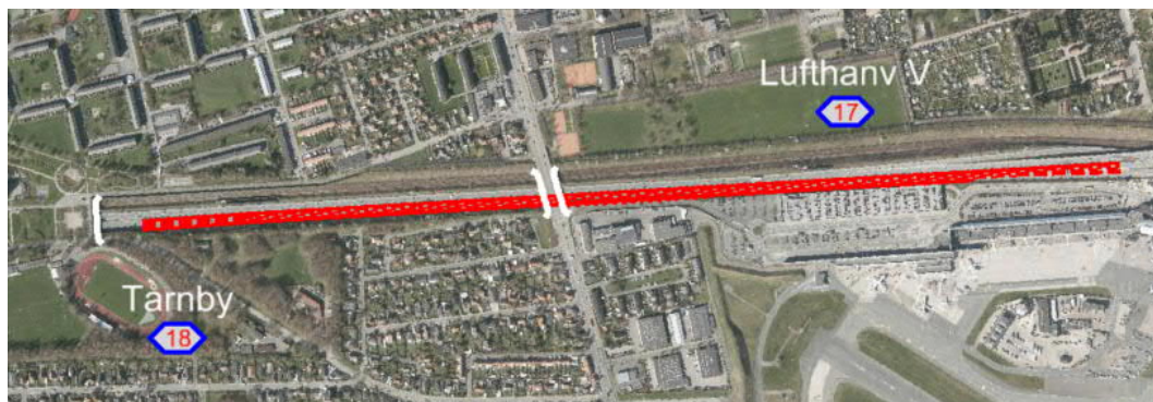
Figur 25 Etablering af et tredje spor mellem TSA18 og TSA17 i østgående retning. Enten i form af en ITS-løsning, konvertering af nødsporet eller egentlig udbygning
