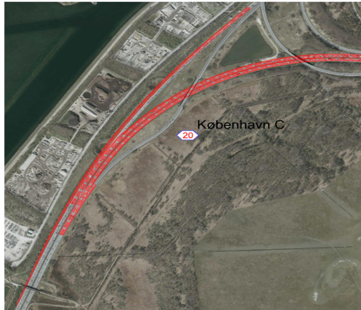
Figur 28 Principskitse der viser hvordan Amagermotorvejen tilsluttes Øresundsmotorvejen som rampe Rampetilslutningen (i tilfælde af 2 rampespor) kan enten udføres svarende til type B
